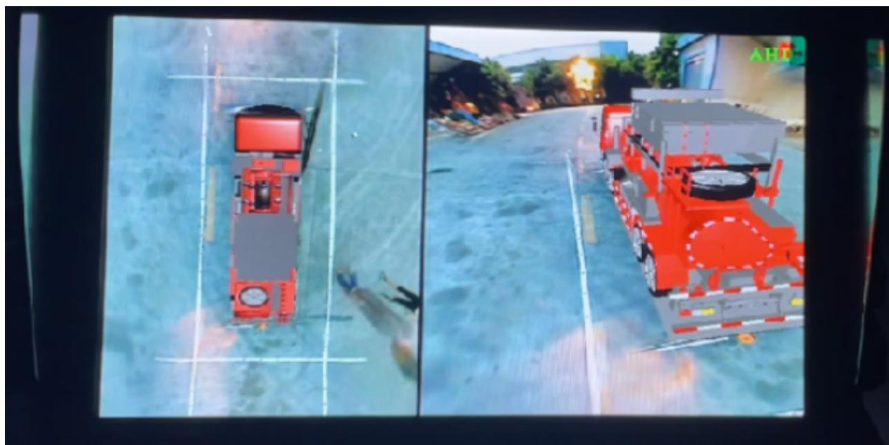
工程车360度全景影像系统的研发背景：倒车，一直是广大司机头疼的问题，再有经验的司机也有过刮碰经历。很多新手不怕开车，就怕倒车，一倒车就手忙脚乱。虽然有倒车雷达，但车后的小孩、石头、大坑等又不可以被倒车雷达识别，极易引起事故。因而，从原来的倒车语音到超声波探头，再到流行的可视倒车雷达，倒车系统一直在发展进步。现如今，单个后视摄像头的可视倒车雷达产品已俨然成为工程车的必备安全装备之一。但同时，基于单个后视摄像头的可视倒车雷达只可以看到车身正后方影像，无法同时看清车身四周状况，存在视角盲区，难以满足驾驶员越来越苛刻的驾驶要求，因此就有了车身周围360度全景影像的需求，360度全景倒车影像由此诞生。
